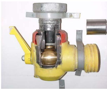
Abbildung 8.1: Hauptabsperreinrichtung (Darstellung Teilaufschnitt)
