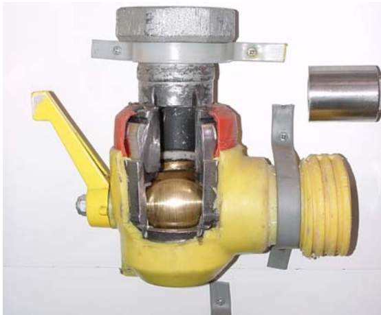
Hauptabsperreinrichtung (Darstellung Teilaufschnitt)
